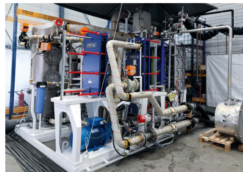
Le système de propulsion à l'hydrogène K2 développé par Koedood et Kooiman est testé avant d'être installé.
