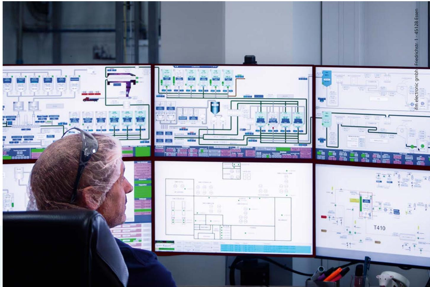
*Monitoraggio centralizzato del processo: grazie alla comunicazione digitale tramite AS-i e IO-Link, è possibile monitorare centralmente l'intero processo.*
