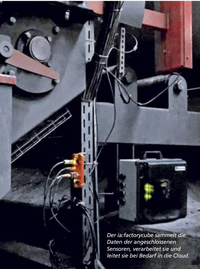
Der ia:factorycube sammelt die Daten der angeschlossenen Sensoren, verarbeitet sie und leitet sie bei Bedarf in die Cloud.
