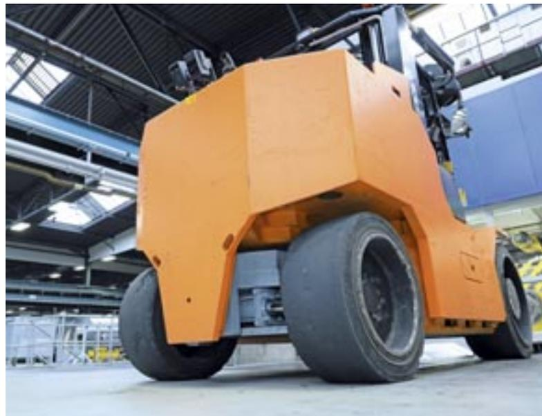
*Die 3D-Kamera des Kollisionsschutzsystems ist hier in Augenhöhe montiert und überwacht den Rückbereich des Staplers.*
