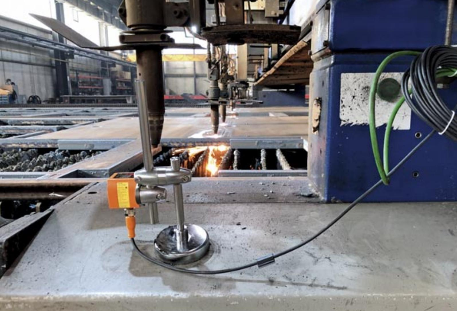
*Der Distanzsensor O1D108 erkennt mittels Lichtlaufzeitmessung, ob der Schneidekopf in Betrieb ist oder sich in der Ruheposition befindet.*
