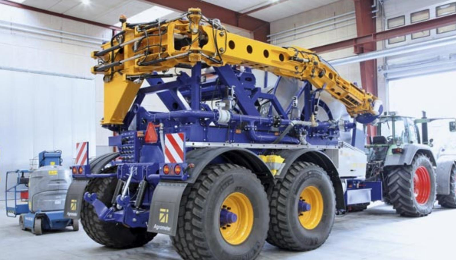
*Der gelbe Ausleger legt den bis zu mehrere hundert Meter langen Zuführungsschlauch in Kurven geordnet auf dem Feld ab, sodass dieser geordnet und verwindungsfrei ab- und aufgerollt werden kann.*
