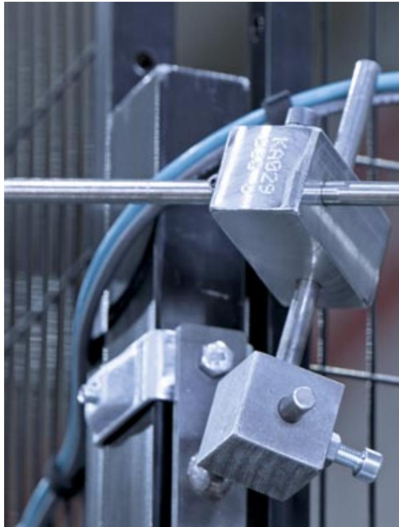
Von Hand legt der Werker verschiedene vorbereitete Blechteile übereinander in eine Vorrichtung, damit sie anschließend von einem Schweißroboter an mehreren Punkten miteinander zu einer Einheit verschweißt werden können. Zur Fixierung der Blechteile dienen sogenannte Kniehebelspanner. Das sind L-förmige Hebel, welche herunterklappen und die Bleche von oben in der Vorrichtung fixieren.
