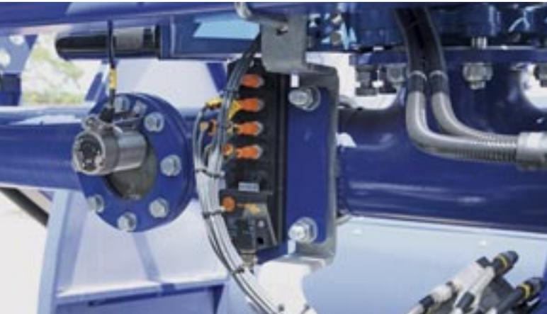
Robuste dezentrale EIA-Module nehmen Sensor-signale auf und leiten sie per CAN-Bus an die SPS.
