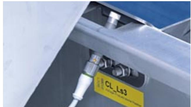
Nur wenn das Spaltsieb nach der manuellen Reinigung wieder korrekt eingesetzt wurde, gibt der induktive Sensor den Wiederanlauf der Produktion frei.
