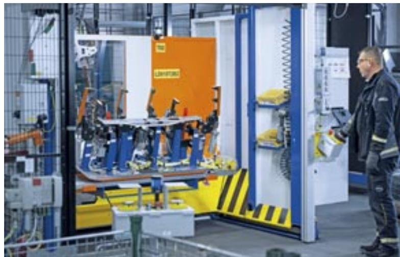
*In der Schweißanlage werden mehrere vorbereitete Bleche zu einem Unterassemble (Subassembly) verschweißt.*
