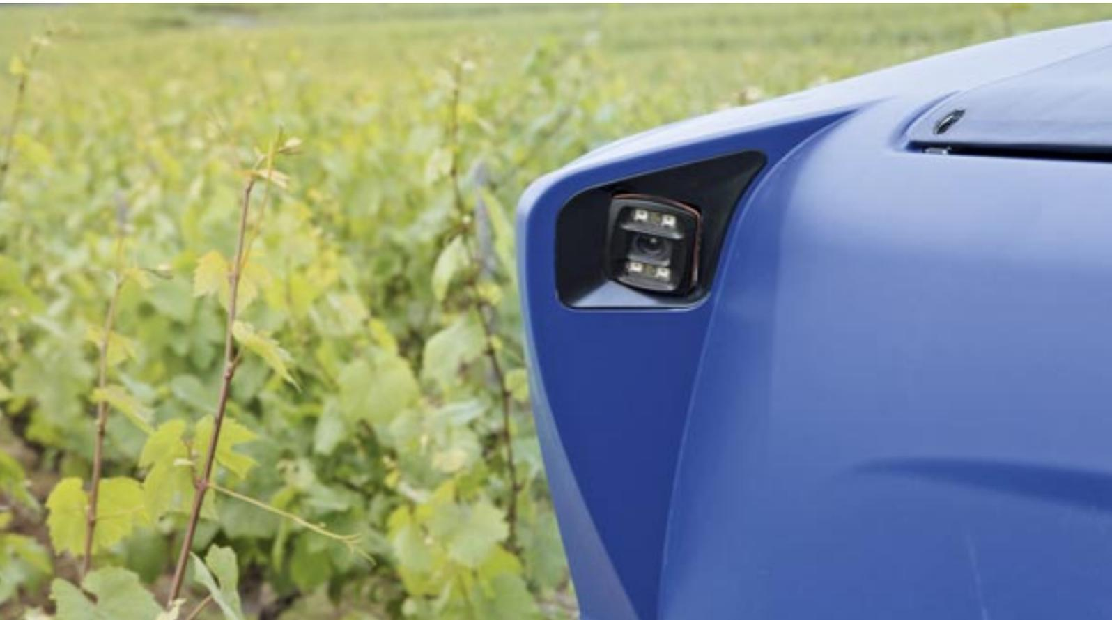
PMD-Technologie (= Photo-Misch-Detektor) ein 3D-Bild. Die Auflösung des PMD-Bildsensors beträgt 176 mal 132 Bildpunkte. Zu jedem einzelnen der 23.232 Bildpunkte liefert die Kamera einen präzisen Abstandswert – bis zu 25 Mal in der Sekunde. Anders als bei Laserscannern benötigt die ifm-3D-Kamera keine beweglichen Teile. Das macht sie besonders robust, klein, leicht und kostengünstig. Durch die verwendete PMD-Technik arbeitet der Bildsensor losgelöst vom Umgebungslicht.
