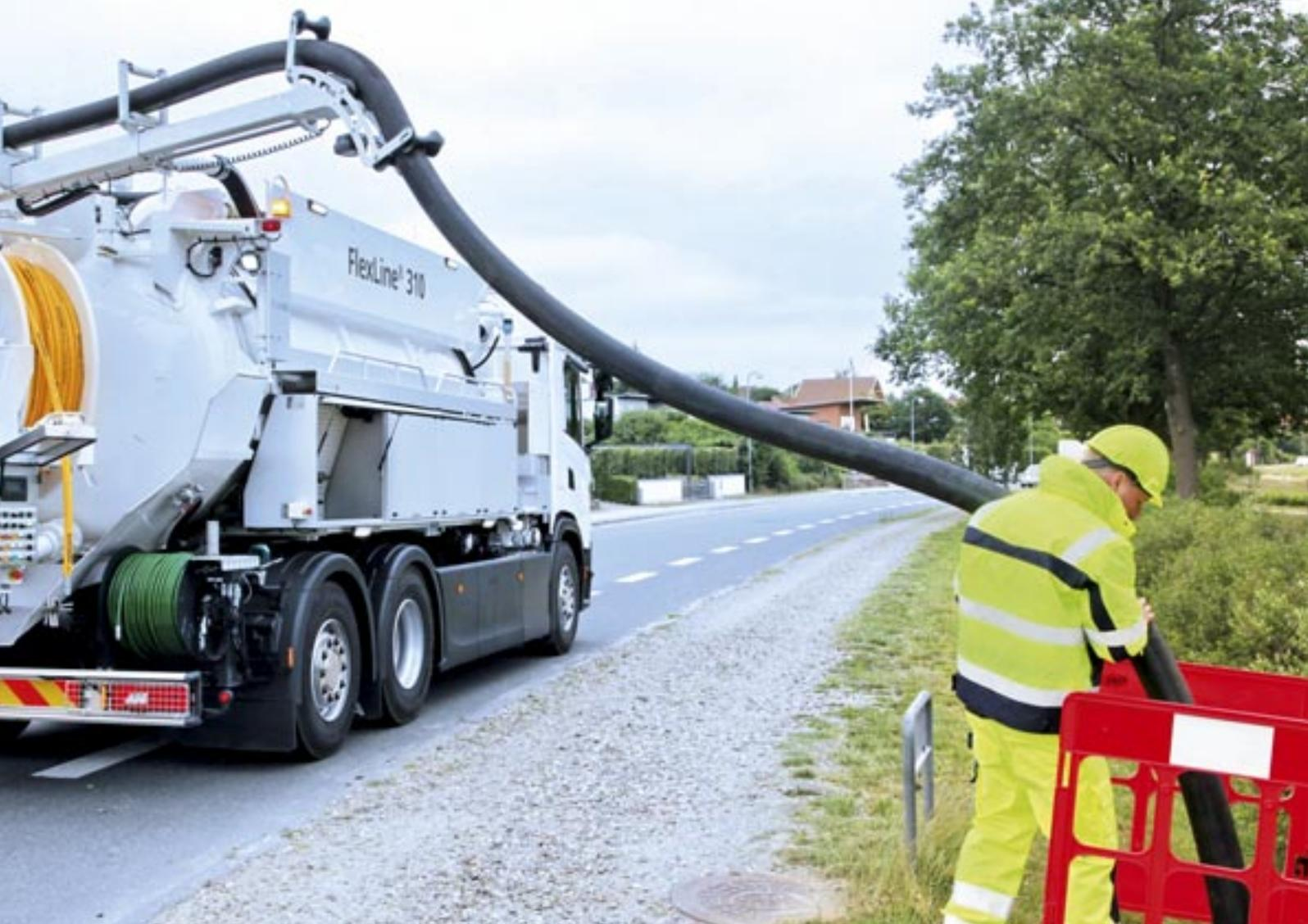
Kanalreinigungsfahrzeug mit Spül- und Saugpumpe zur Reinigung von Abwasserkanälen.
