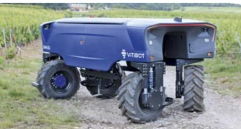
Selbständiges Wendemanöver: Dank mehrerer 3D-Kameras wird möglichen Hindernissen ausgewichen und die Rebzeilen exakt mittig angefahren.
