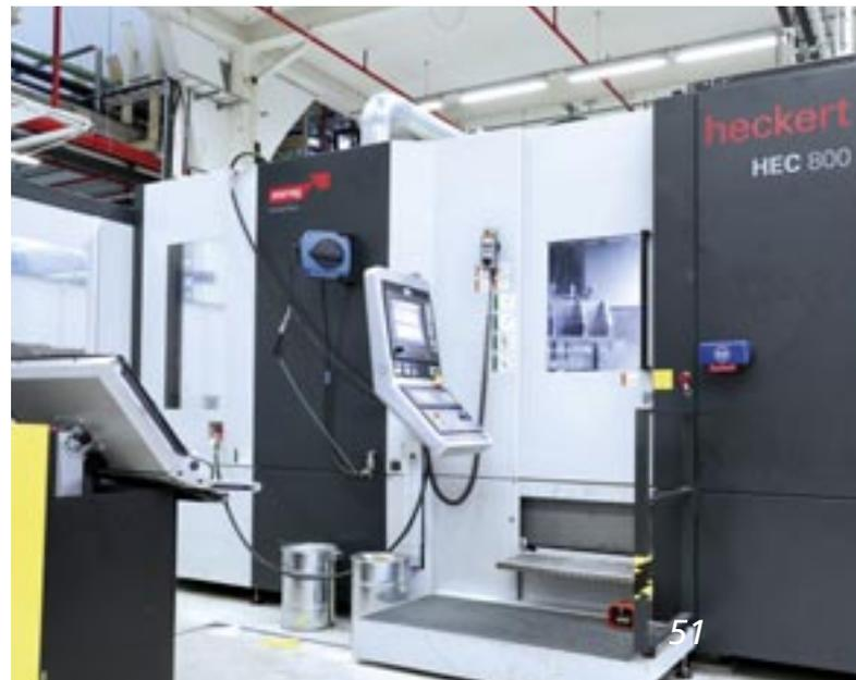
*5-achsige Werkzeugmaschine zum Drehen, Bohren und Fräsen großer Metallblöcke.*
