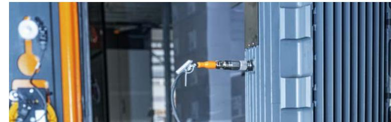
*Sensores de aceleração altamente sensíveis detectam a tempo os danos e desgastes em componentes críticos, como o rolete e o acionamento, por meio do monitoramento constante de suas vibrações.*
