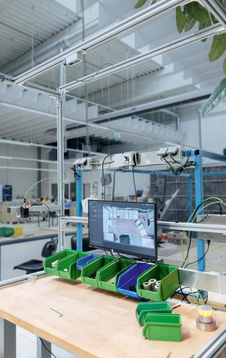
*ifm mate como solução completa: A câmera (acima da estação de trabalho), o software e o computador podem ser perfeitamente expandidos para incluir uma tela tátil, sinalizador luminoso (canto inferior direito da foto) e o sensor de visão O2D5 (lado esquerdo da foto, montado na barra transversal).*
