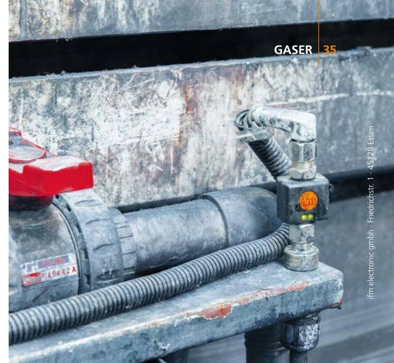
*O sensor de temperatura, a unidade de avaliação e o cabo resistem às rigorosas condições do processo de anodização.*
