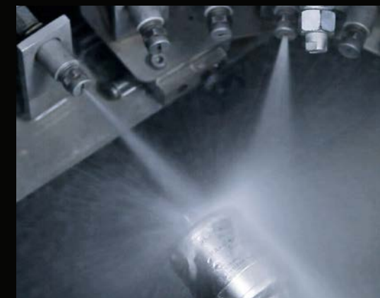
Resistente in condizioni estreme: test per il grado di protezione IP 69K.
