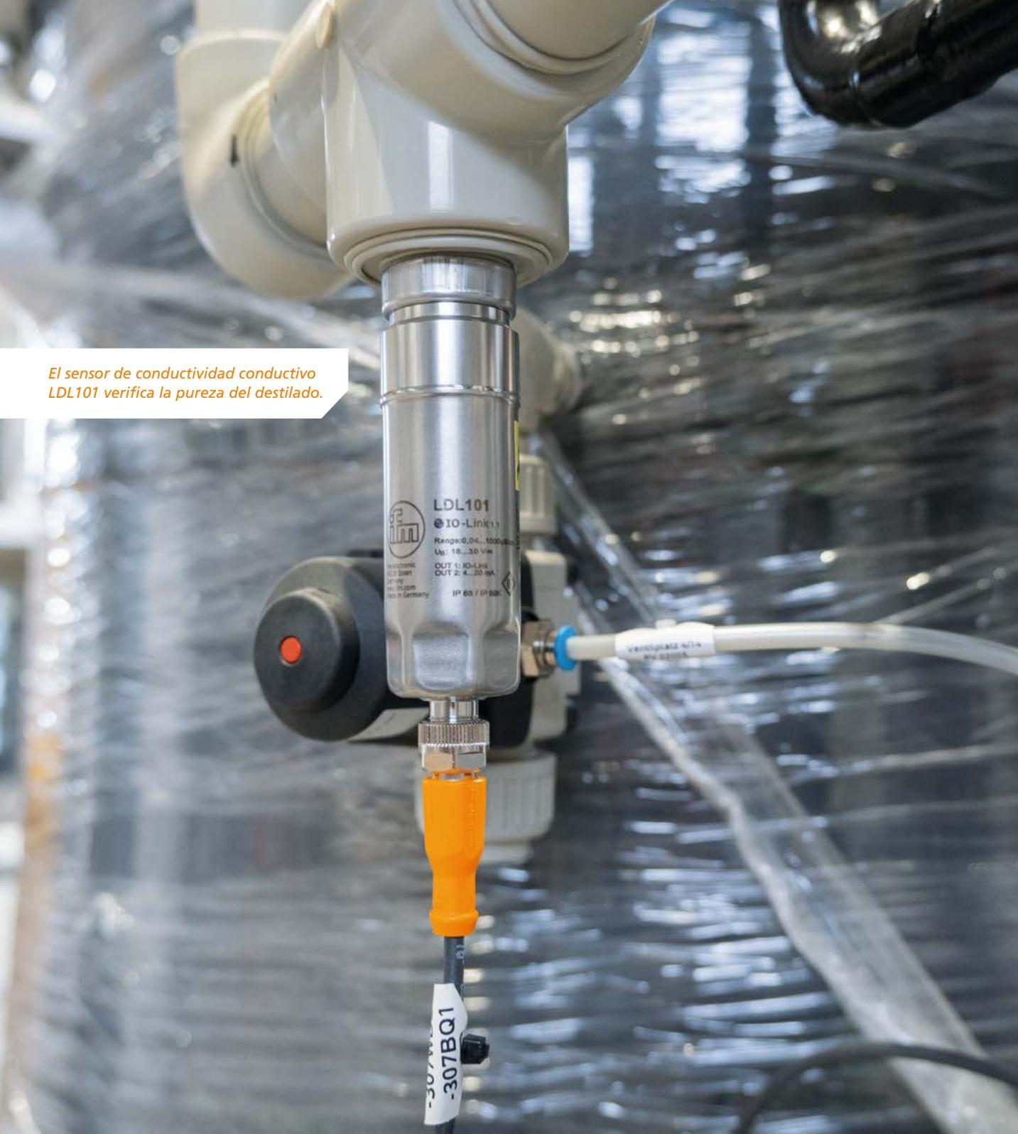
El sensor de conductividad conductivo LDL101 verifica la pureza del destilado.
