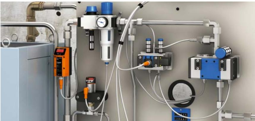
**Druckluftaufbereitung für die Sperrluft**
