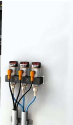
**Vakuumsensoren überwachen Sauggreifer**
