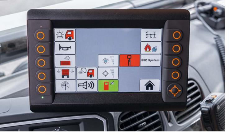
Pelo display gráfico programável CR1082 no cockpit, o condutor pode controlar todas as funções especiais e agregados.
