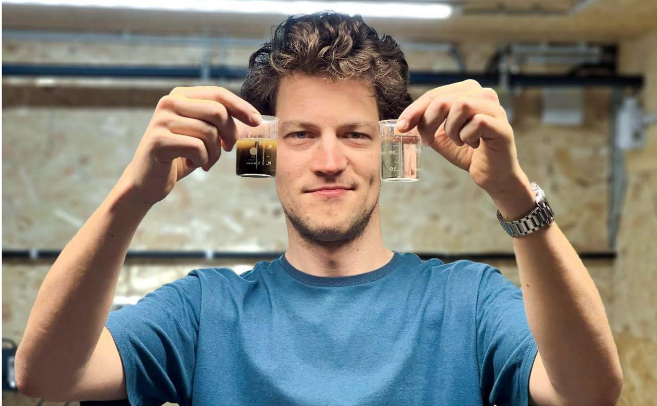
*Aymar de Lichtervelde examine deux échantillons d'eau : à gauche les eaux usées introduites à l'entrée du système (ici eaux noires), à droite l'eau purifiée qui peut être recyclée ou restituée à l'environnement sans contamination.*
