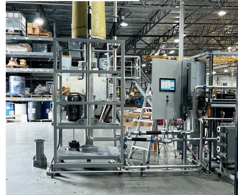
システム全体の中心：メンブレン膜を振動させる20HPのモーターが取り付けられたろ過装置。
