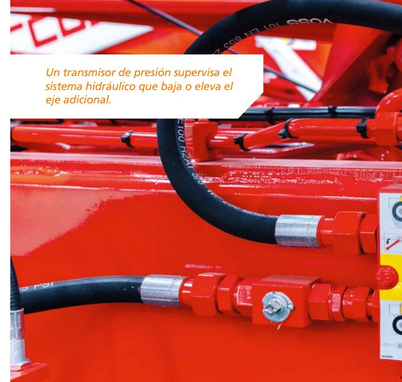
*Un transmisor de presión supervisa el sistema hidráulico que baja o eleva el eje adicional.*
