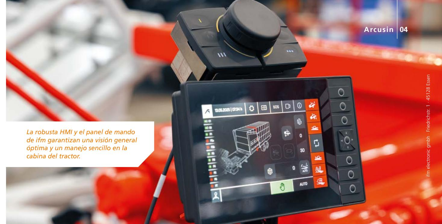
*La robusta HMI y el panel de mando de ifm garantizan una visión general óptima y un manejo sencillo en la cabina del tractor.*
