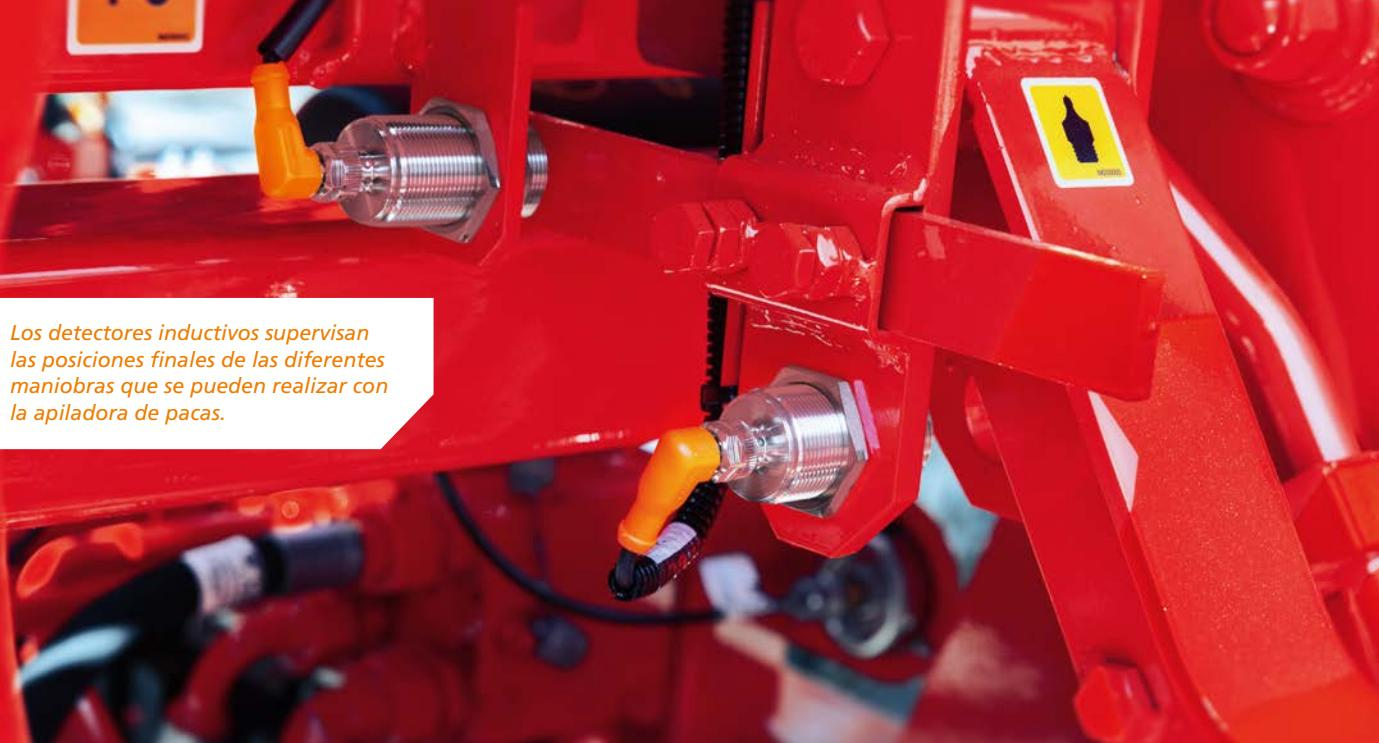
*Los detectores inductivos supervisan las posiciones finales de las diferentes maniobras que se pueden realizar con la apiladora de pacas.*
