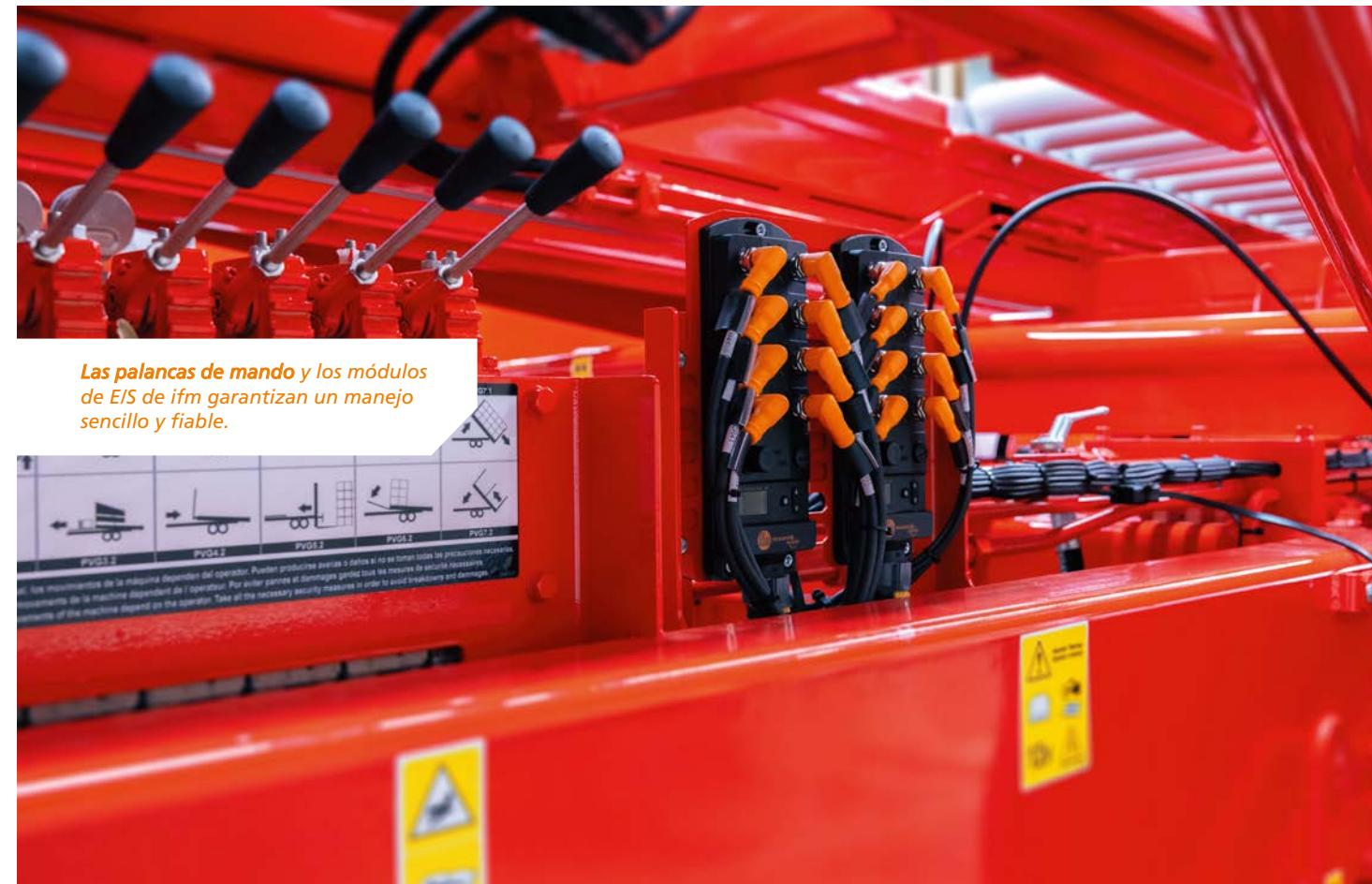
*Las palancas de mando y los módulos de E/S de ifm garantizan un manejo sencillo y fiable.*
