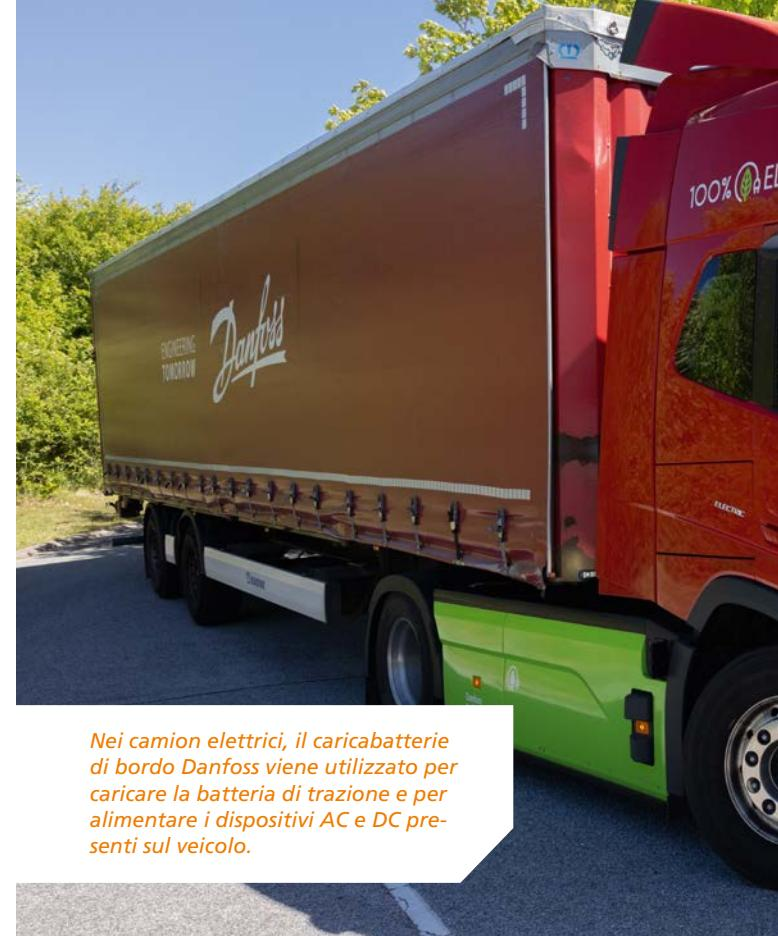
*Nei camion elettrici, il caricabatterie di bordo Danfoss viene utilizzato per caricare la batteria di trazione e per alimentare i dispositivi AC e DC presenti sul veicolo.*
