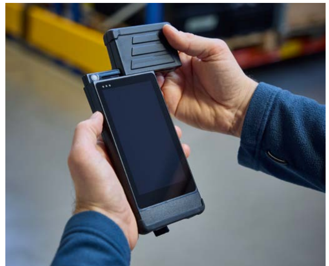
Die verschiedenen Antennen-Module an der Oberkante des Handhelds lassen sich einfach austauschen.
