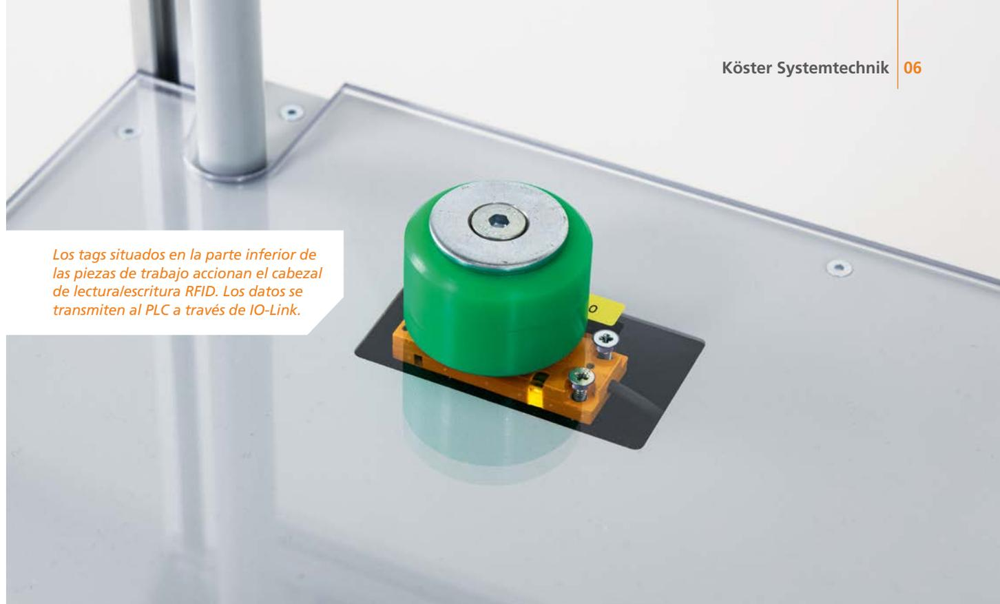
Los tags situados en la parte inferior de las piezas de trabajo accionan el cabezal de lectura/escritura RFID. Los datos se transmiten al PLC a través de IO-Link.
