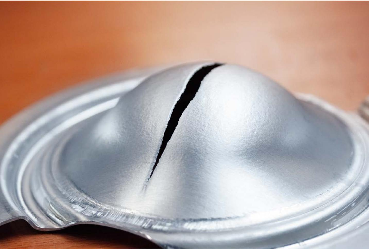
테스트 표본은 Nakajima 테스트의 전형적인 균열 형성을 보여줍니다. 예를 들어, 소재의 목표 과부하를 가하면 자동차 부품으로 성형할 수 있는지 여부에 대한 정보를 얻을 수 있습니다.
