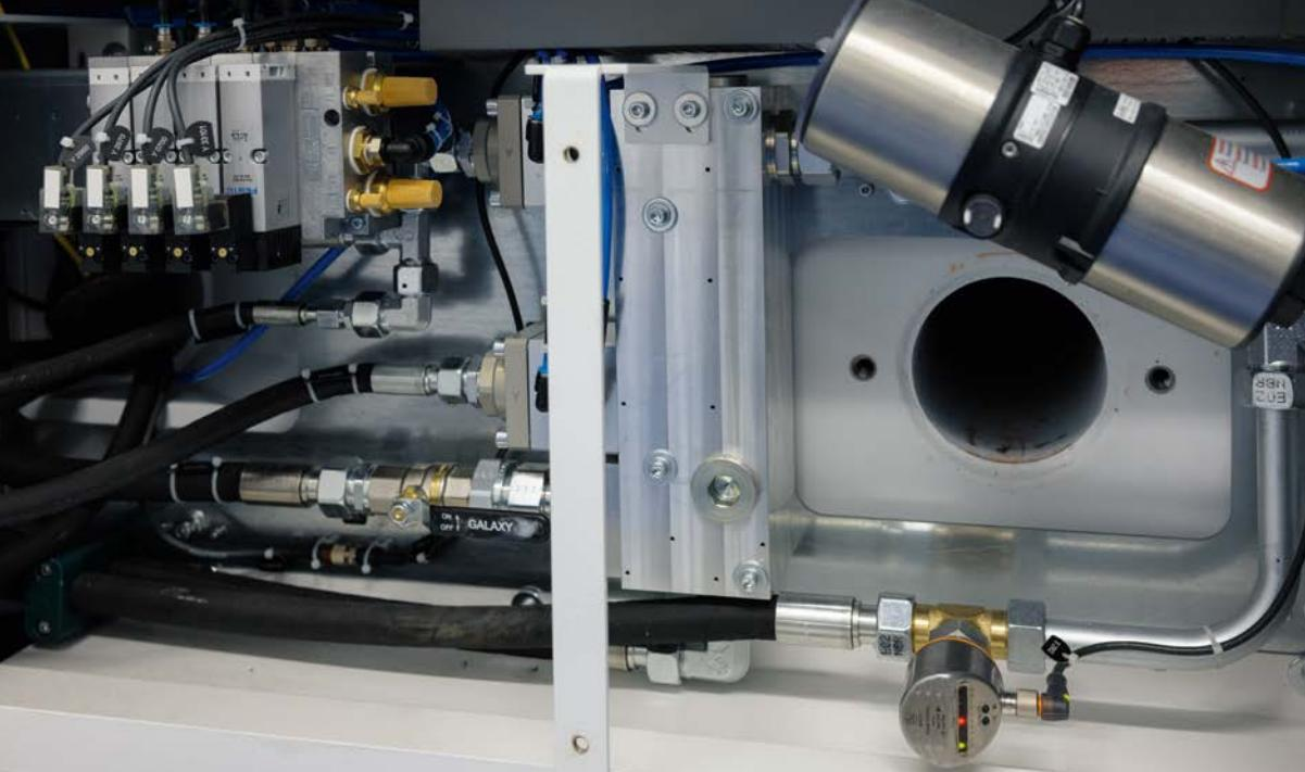
O monitor de fluxo detecta a velocidade de alimentação do líquido de arrefecimento é alimentado no processo de usinagem. A barra de LEDs indica o comportamento do fluxo.
