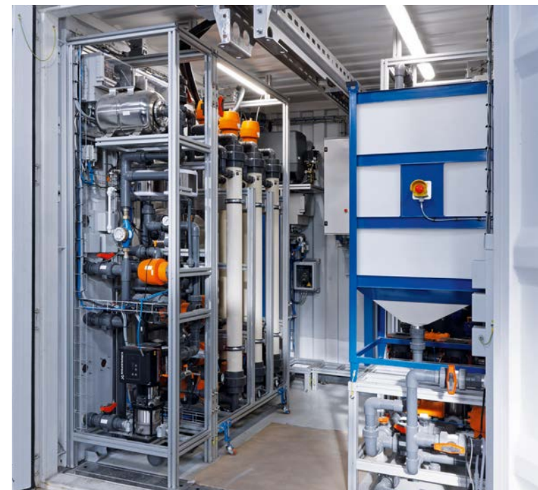
Il sistema completo di trattamento dell'acqua è integrato in un contenitore compatto.
