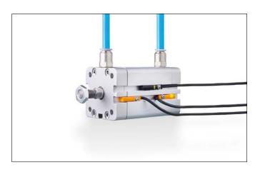
配有一個感應器,而不是兩個:在短動程氣缸上,一個 IO-Link 氣缸感應器 (上凹槽) 現在足以檢測兩端位置,而不是像以前那樣使用兩個傳統感應器 (下凹槽)。
