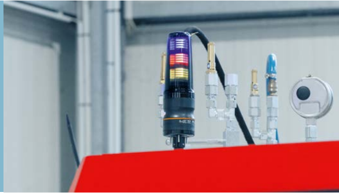
IO-Link 기반 LED 라이트 타워는 멀리서도 선명하게 보이고 부저가 내장되어 있습니다.
