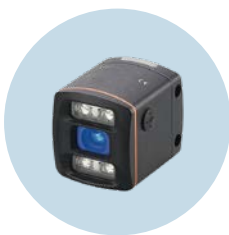
O3D 3D 感應器 針對物體測量，抓爪導航等
