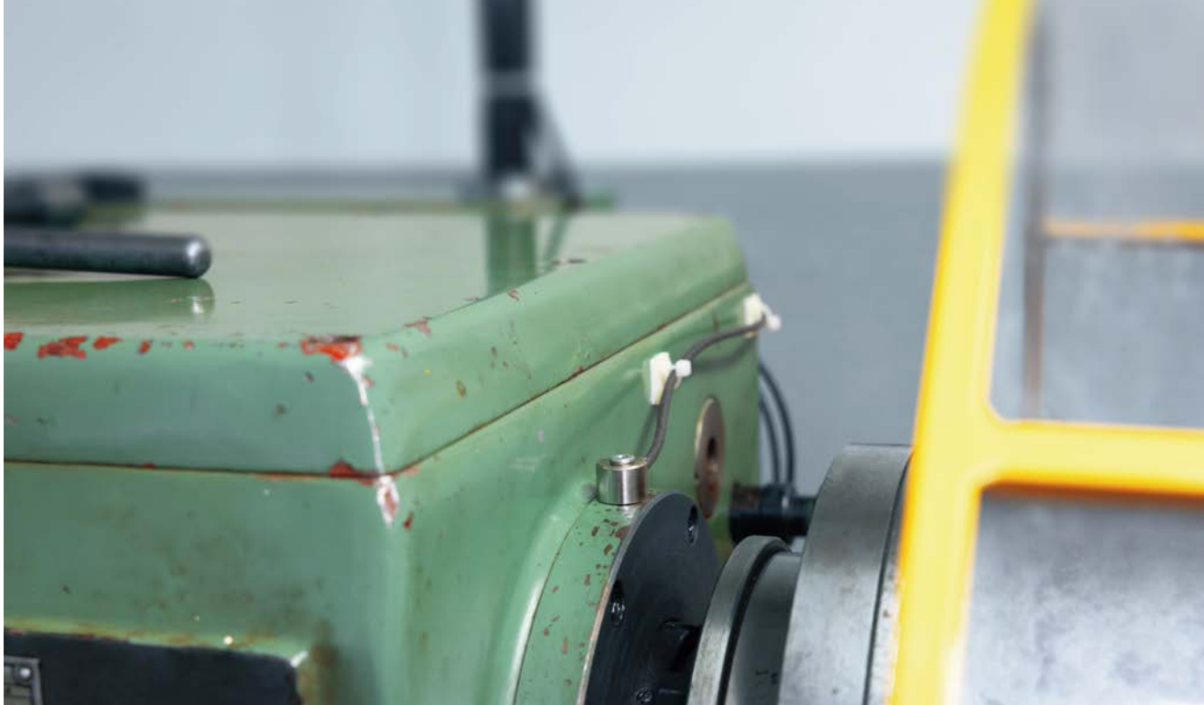
O “ouvido” da máquina: o sensor de vibração VSA005 registra os espectros de vibração de todos os rolamentos no acionamento da máquina.
