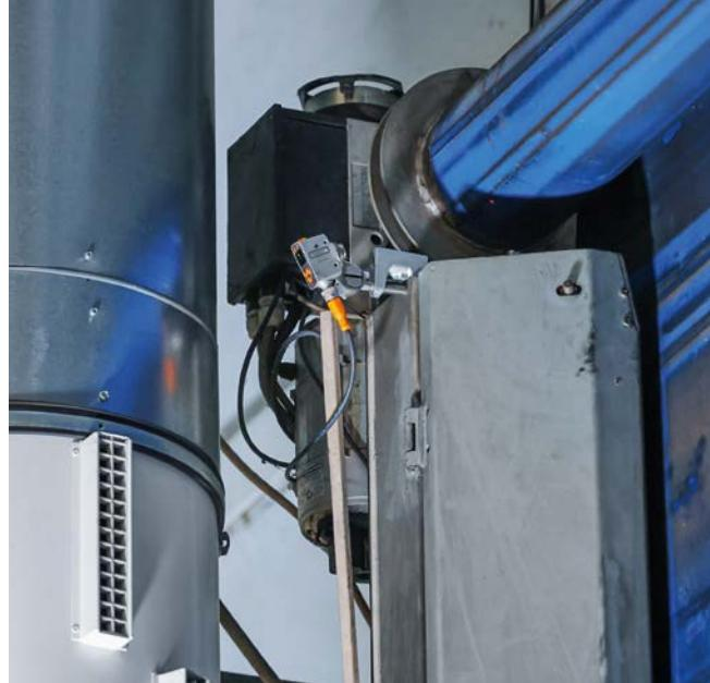
光電センサにより扉の開閉を検出します。
