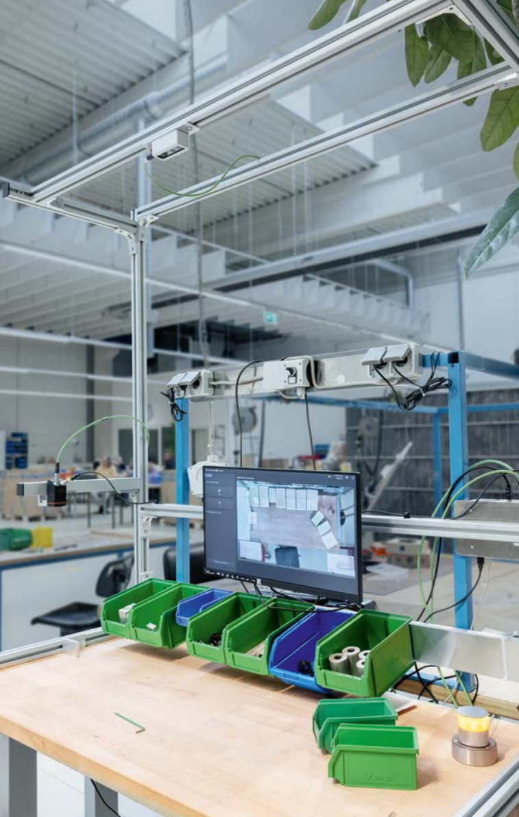
ifm mate als Gesamtlösung: Kamera (über dem Arbeitsplatz), Software und Rechner können nahtlos um Touchscreen, Signalleuchte (unten rechts im Bild) und den Vision-Sensor O2D5 (linker Bildrand, am Querträger montiert) erweitert werden.
