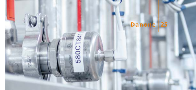
Der Leitfähigkeitssensor LDL200 sichert den korrekten und effizienten Ablauf des CIP-Prozesses.
