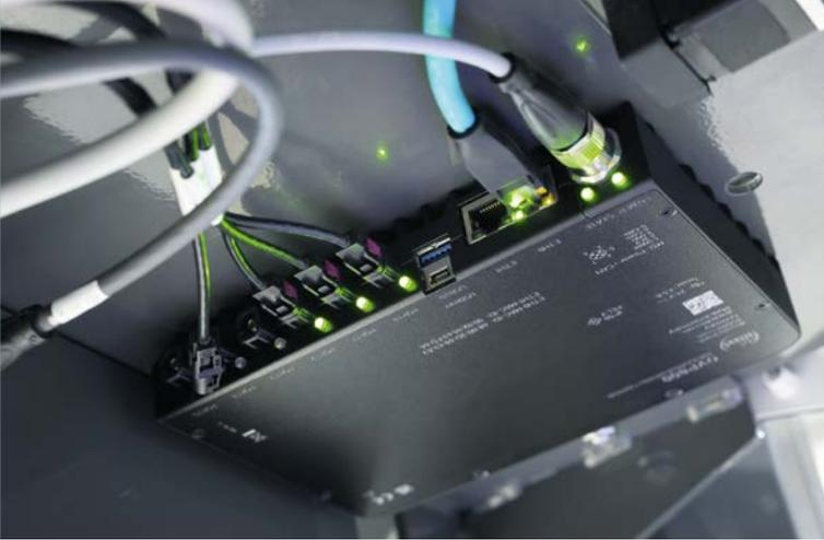
Zentraler Bestandteil des O3R-Systems ist die Video Processing Unit. Sie bietet Anschlussmöglichkeiten für bis zu 6 Kameras.
