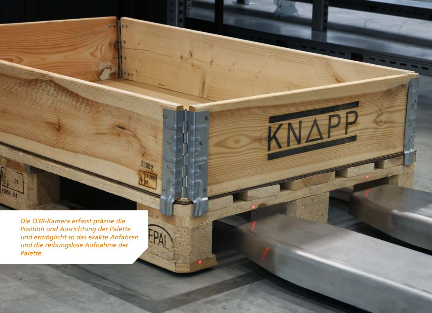
Die O3R-Kamera erfasst präzise die Position und Ausrichtung der Palette und ermöglicht so das exakte Anfahren und die reibungslose Aufnahme der Palette.
