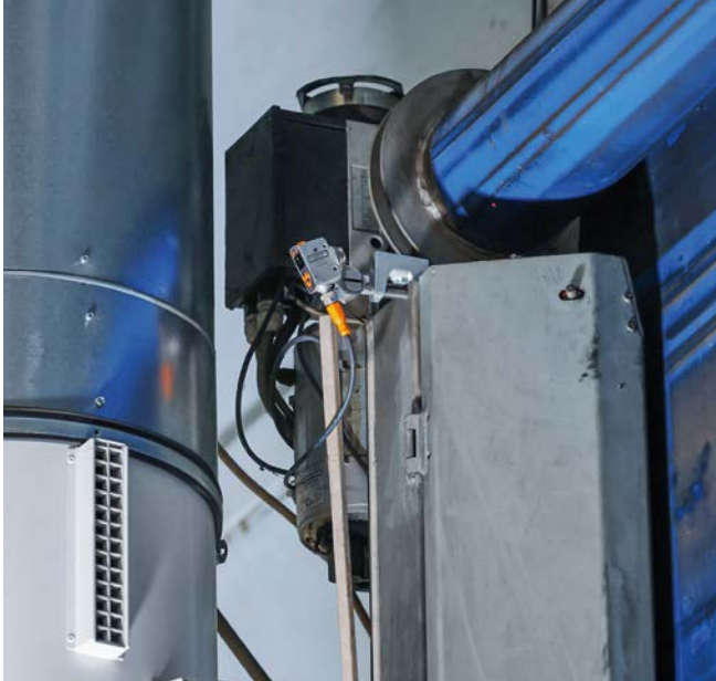
Ein optischer Sensor überprüft, ob das Tor geöffnet oder geschlossen ist.
