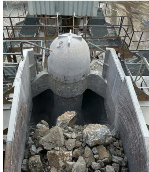
Ein zentraler Prozessschritt ist die Überwachung des Füllstands im sogenannten Kreiselbrecher. Hier darf ein definierter Grenzwert nicht überschritten werden, um eine Überfüllung zu vermeiden, insbesondere da der Brecher kontinuierlich über ein Förderband beschickt wird. Die rauen, staubigen Umgebungsbedingungen erschweren jedoch eine zuverlässige Messung. Dennoch ist eine präzise Füllstandüberwachung essenziell für einen reibungslosen und sicheren Betrieb.
