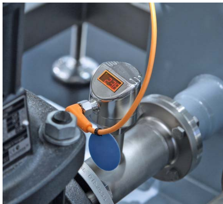
Sehr kurze Ansprechzeit und ein Display zeichnen den Temperaturtransmitter TD2237 aus.
