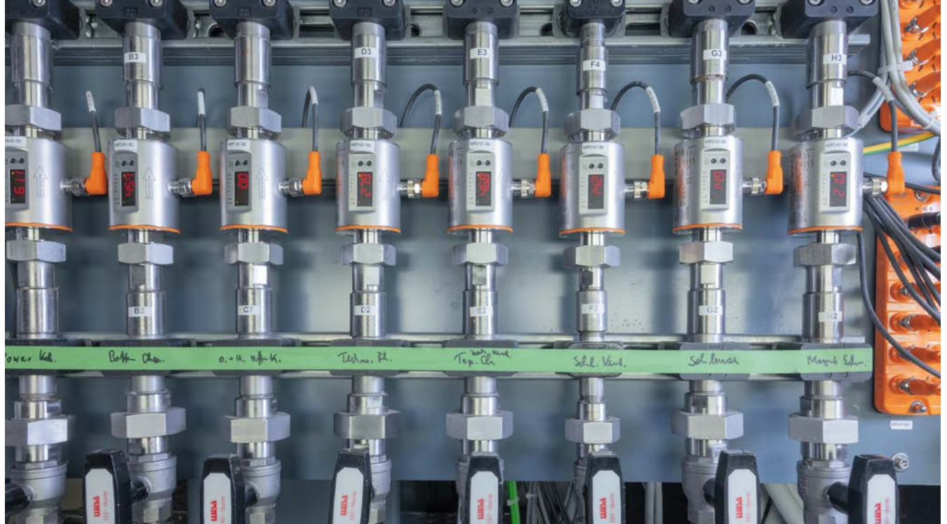
Durchflusssensoren überwachen den Kühlkreislauf der Czochralski-Anlage.
