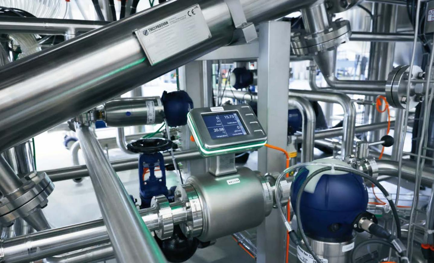
SM Foodmag 可同時偵測流量、導電率和溫度 - 均透過同一個測量點。
