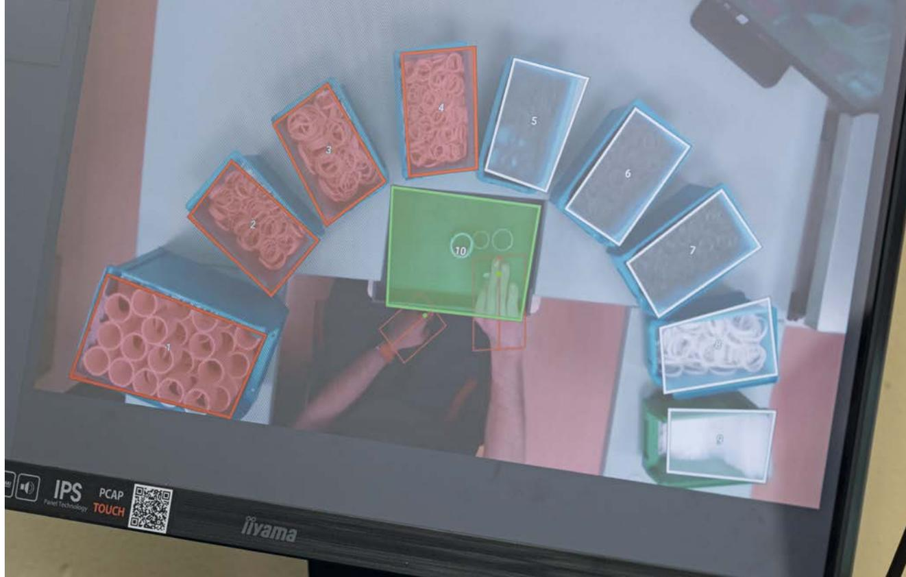
*L'operatore viene guidato attraverso il processo di confezionamento tramite un display. Il software elabora la posizione, l'orientamento e l'altezza della mano garantendo così la corretta esecuzione dei singoli passaggi. I colori per l'orientamento visivo dell'operatore possono essere definiti liberamente.*
