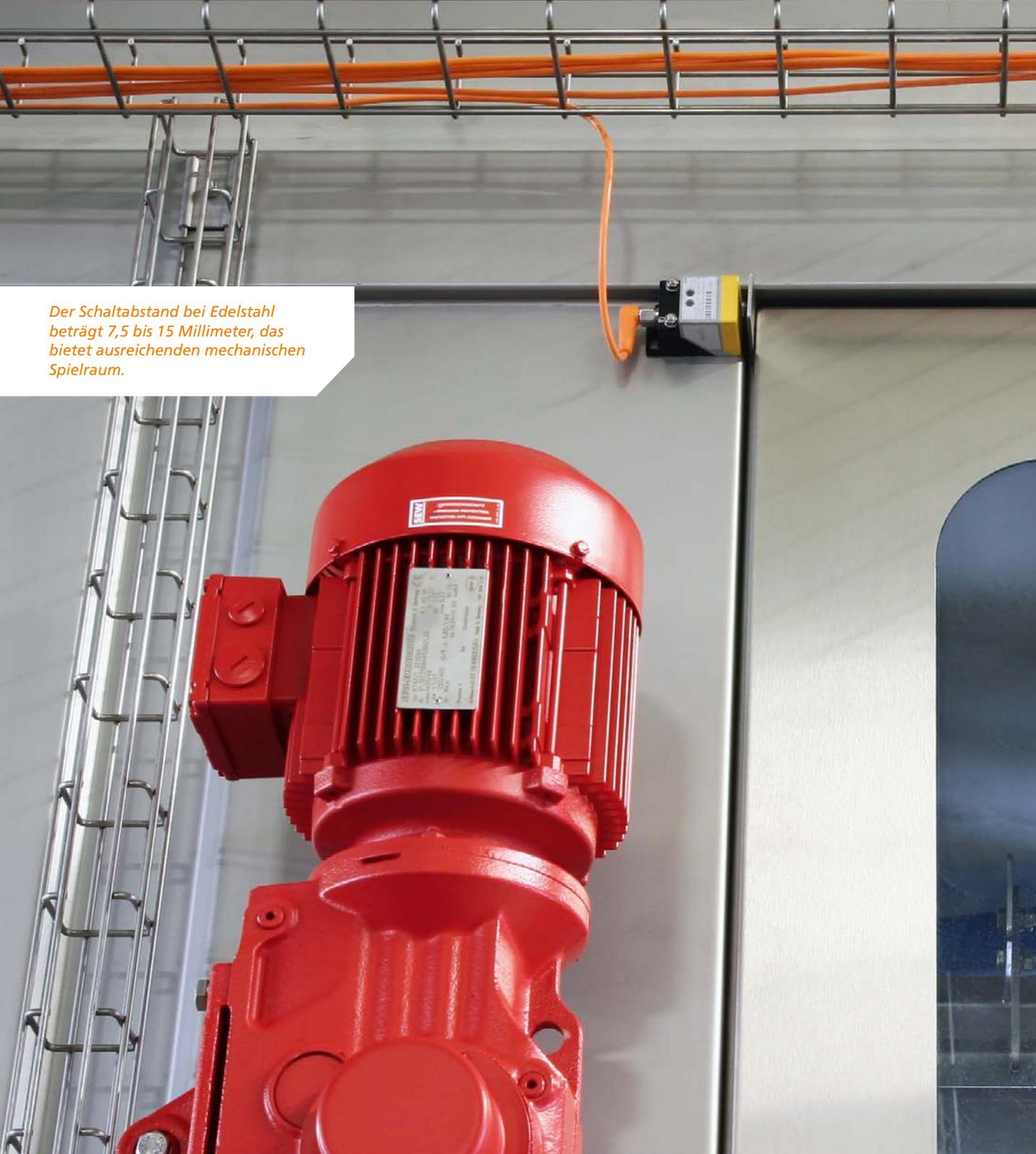
Der Schaltabstand bei Edelstahl beträgt 7,5 bis 15 Millimeter, das bietet ausreichenden mechanischen Spielraum.
