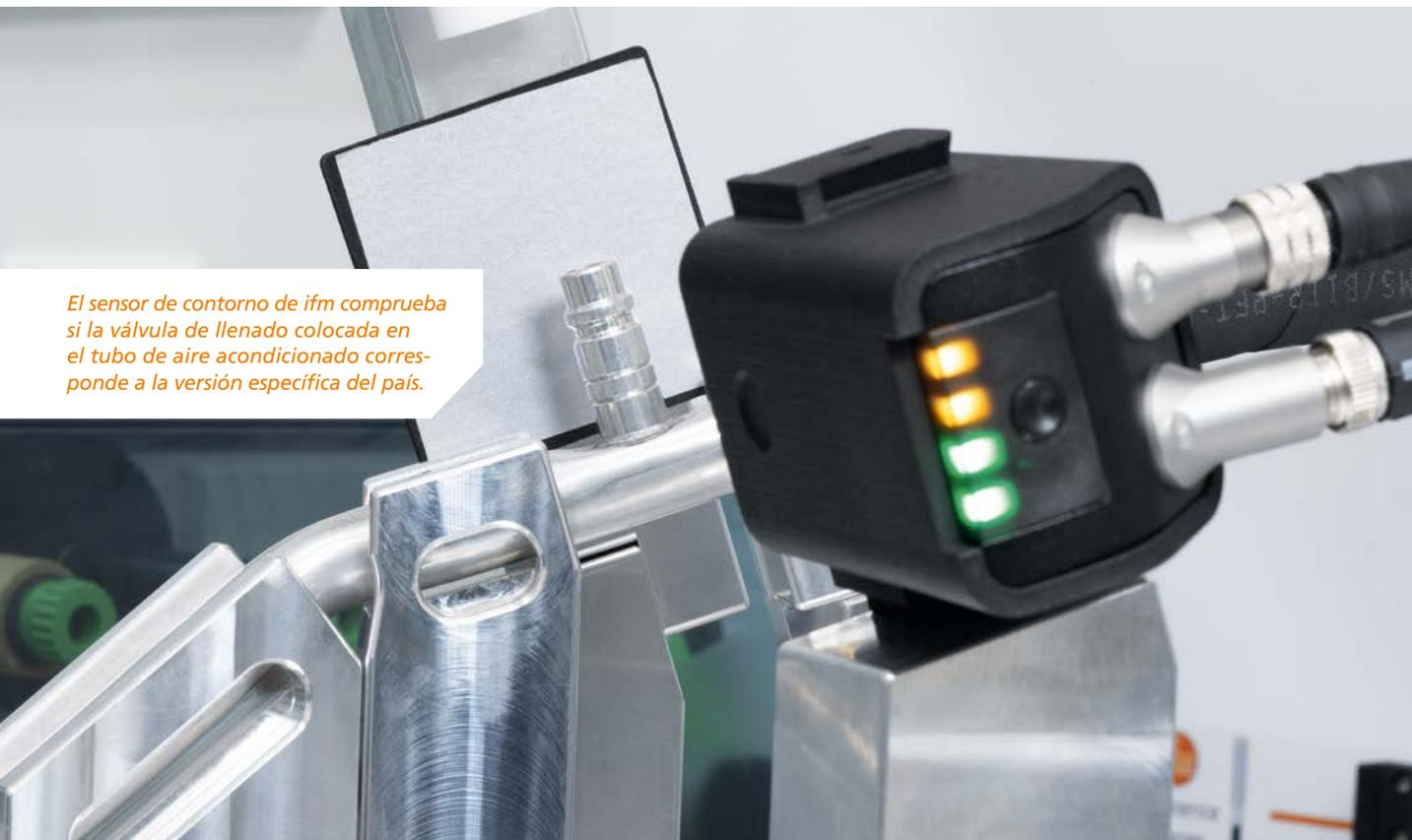
*El sensor de contorno de ifm comprueba si la válvula de llenado colocada en el tubo de aire acondicionado corresponde a la versión específica del país.*
