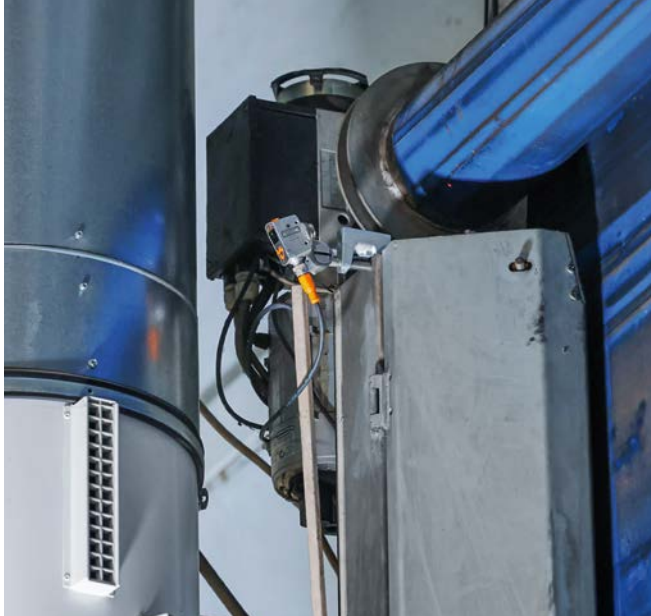
Un détecteur optique contrôle si la porte est ouverte ou fermée.
