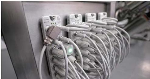
„Rau“ Einsatzbedingungen in der Lebensmittelproduktion aufgrund von Reinigungsprozessen unter Einsatz von Hochdruck und Chemikalien bringen IO-Module oftmals an ihre Grenzen. Die erforderliche IP-Schutzklasse wird von vielen Herstellern nicht erfüllt, sodass ein zusätzlicher Schaltschrank zum Schutz der Technik erforderlich ist. Das macht die Lösung aufwändig und teurer.
