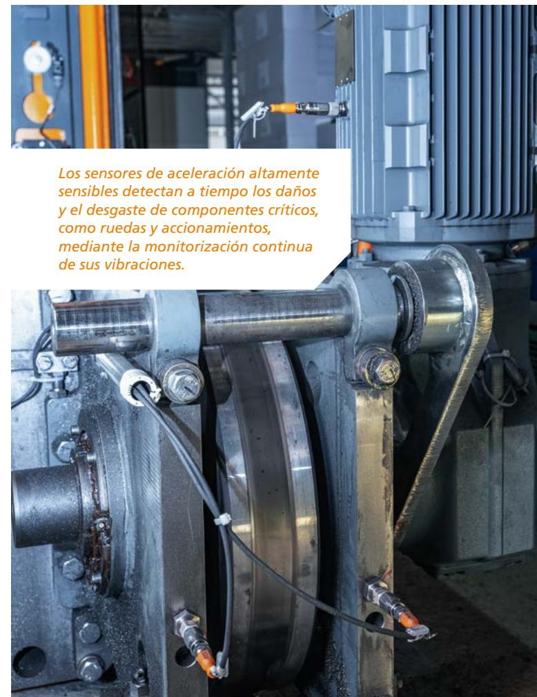
*Los sensores de aceleración altamente sensibles detectan a tiempo los daños y el desgaste de componentes críticos, como ruedas y accionamientos, mediante la monitorización continua de sus vibraciones.*
