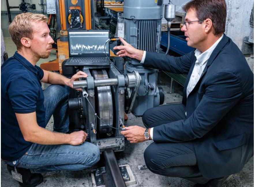
*El software de diagnóstico moneo interpreta los datos de vibración y emite una alarma si se superan los valores límite. Esto permite alinear y ajustar los componentes in situ con gran precisión.*
