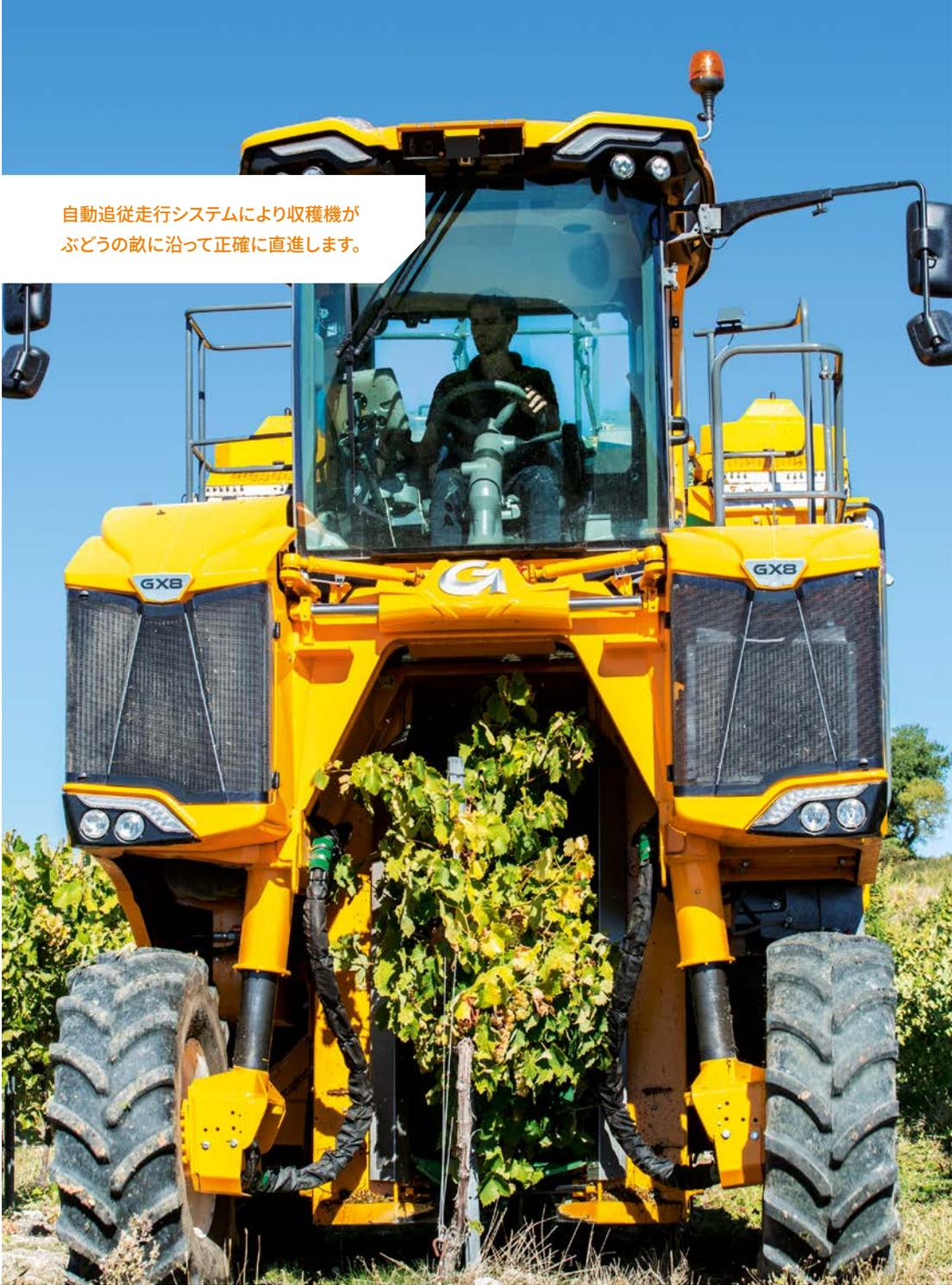
自動追従走行システムにより収穫機がぶどうの畝に沿って正確に直進します。
