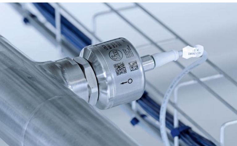
El sensor de conductividad LDL200 detecta de forma fiable si existe en las tuberías agua limpia o líquido de limpieza del proceso CIP. Al mismo tiempo, mide la temperatura y transmite ambos valores de medición al controlador del sistema a través de IO-Link.
