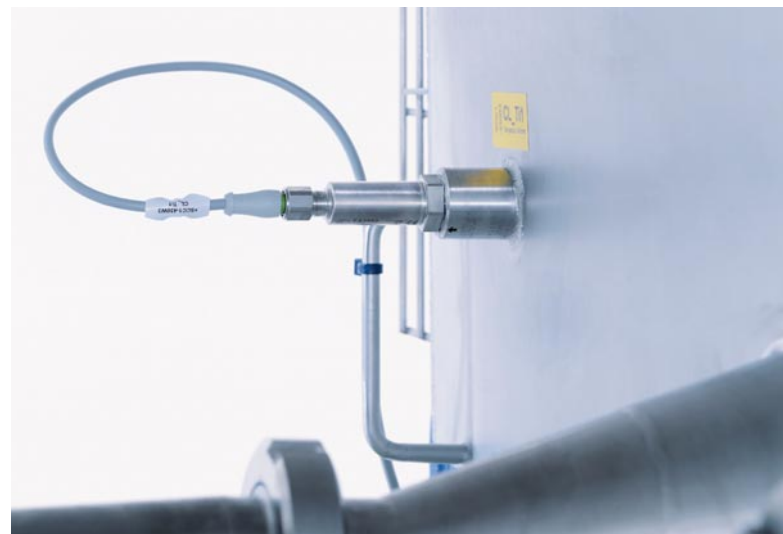
Los sensores de temperatura de la gama TA controlan los valores de temperatura que deben mantenerse de forma precisa tanto en el baño de cocción como en el de enfriamiento.
