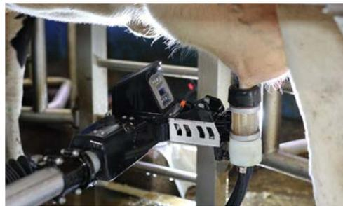
Je präziser und sanfter dies geschieht, desto stressfreier der Vorgang für die Kuh. Und dies wirkt sich letztendlich auch auf die Menge und Qualität der Milch aus. Vor dem Ansetzen der Milchbecher werden die Zitzen noch mit einem Sprühnebel aus Desinfektionsmittel gereinigt. Auch hier liefert die 3D-Kamera der Steuerung ein exaktes 3D-Bild mit allen räumlichen Informationen für ein treffsicheres Heranfahren der Reinigungsdüsen an die einzelnen Zitzen.
