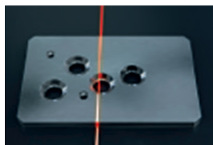
Bohrungen zu groß
