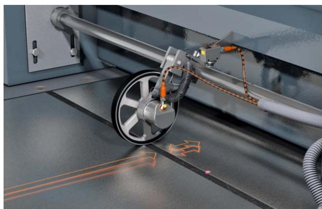
O objeto alvo é detectado por um sensor de posição e a posição final é transmitida em tempo real pela entrada direta no encoder. Assim, sem deslocamento lateral e mecânico, o encoder pode ser ajustado pelo CLP em um valor predefinido (ex.: zero) para medir o objeto alvo de forma precisa. Tarefas subsequentes como de serrar ou outros tipos de processamentos podem ser iniciados. Há redução de custo e de complexidade do cabeamento.
