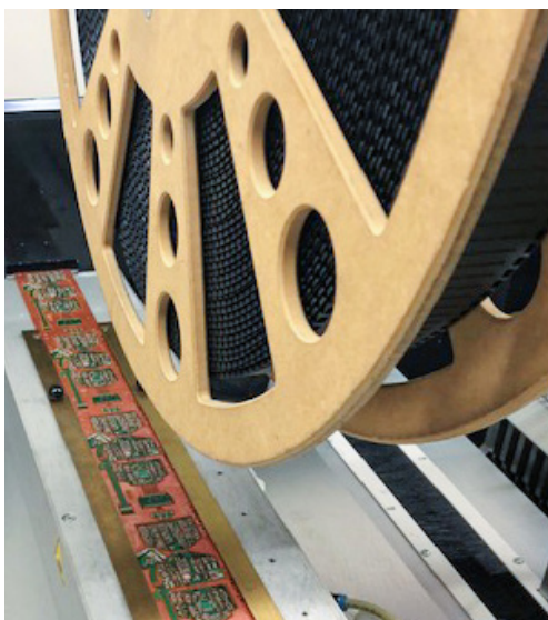
Rolle-zu-Rolle-Prozess zur Herstellung des flexiblen Leiterfilms
