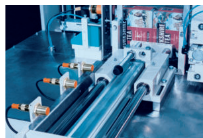
マグネットがスイッチONのポイントに接近するとセンサーがスイッチングします。マグネットの動く方向には左右されません。
