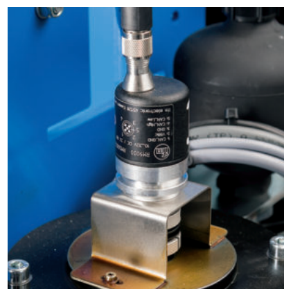
カウンターによる 移動距離測定: 回転運動を デジタル信号に変換
